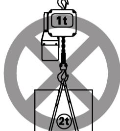
Ne soulevez pas de matériaux qui dépassent la capacité de l'appareil.
