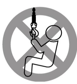
Le palan ne doit jamais être utilisé pour le transport de personnes.
